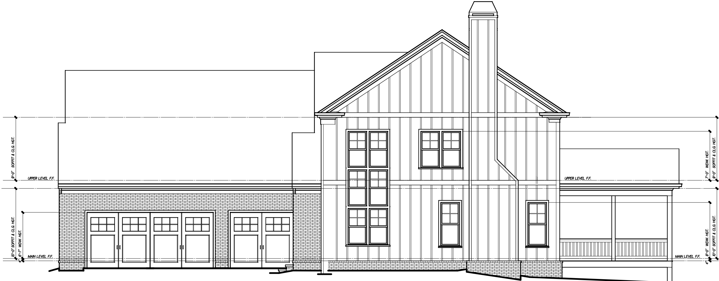
1 RIGHT ELEVATION A6 SCALE: 1/8" = 1'-0"
